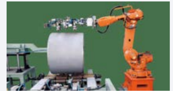
RSSD* 코일 포장용 로봇틀 및 이를 이용한 코일 포장방법 등 8건 특허 * Robot Sheet Setting Device
